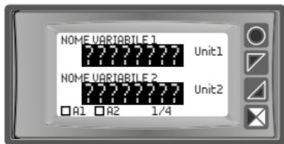
Rappresenta la visualizzazione tipica di variabili in caso di offline. Se il terminale STR571 non riesce a stabilire la connessione con lo slave relativo alla variabile, e quindi non riesce a leggere/scrivere il relativo valore, la visualizzazione numerica viene sostituita da punti di domanda lampeggianti.
