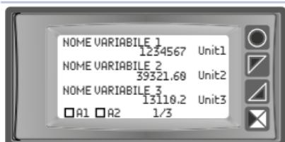
Visualizza il valore delle prime tre variabili abilitate con relative descrizioni ed unità di misura e lo stato dei relè di allarme.
