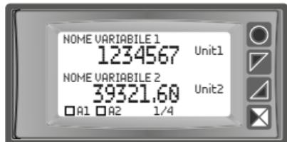
Visualizza il valore delle prime due variabili abilitate con relative descrizioni ed unità di misura e lo stato dei relè di allarme.
