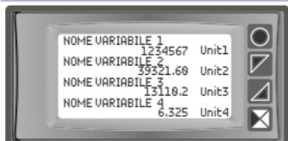
Visualizza il valore delle prime quattro variabili abilitate con relative descrizioni ed unità di misura e lo stato dei relè di allarme.
