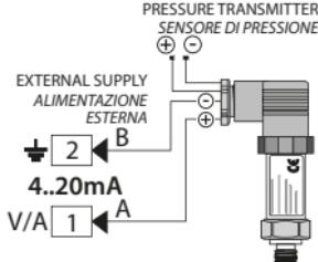
Per segnali normalizzati in corrente 0/4..20 mA con sensore ad alimentazione esterna.
