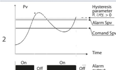
Allarme di deviazione inferiore valore di setpoint allarme minore di "0" e valore di isteresi maggiore di "0" (Par.29 R.I.HY. > 0).\*\*
