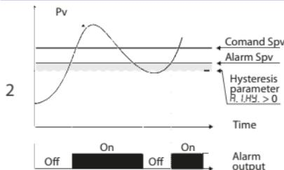
Allarme di deviazione superiore valore di setpoint allarme minore di "0" e valore di isteresi maggiore di "0" (Par.29 R.I.HY. > 0).\*\*
