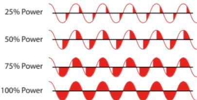
Usando un SSR no zero-crossing l'ATR227 si sincronizza con la tensione di alimentazione (necessariamente AC) e determina quando attivare l'uscita per creare la giusta parzializzazione.
